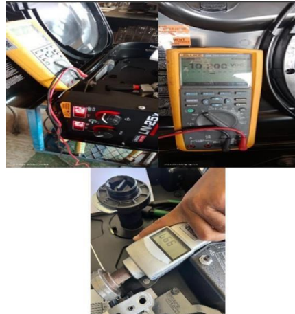
Gambar 6: Ilustrasi proses pengukuran pada welding equipment
