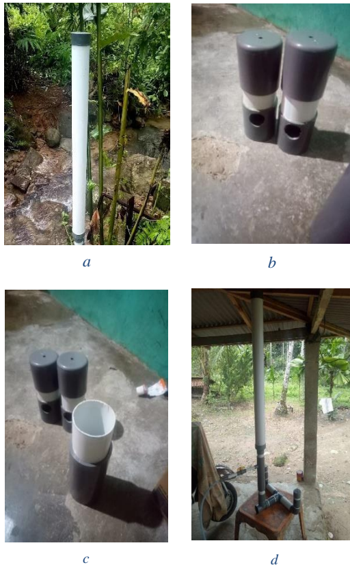
Gambar 8. Hasil perancangan dan pembuatan: a) tabung udara, b) katup limbah, c) katup pengantar, dan d) pompa hidram
