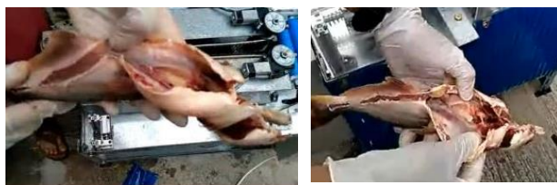
Gambar 7: Hasil pemotongan ikan yang gagal
