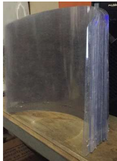
Gambar 8. Hasil Produksi Visor Face Shield Setelah Proses Pemotongan Pada Mesin Cutting
