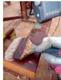
Gambar 6: Aplikasi Couplant Pada Permukaan Benda Uji
