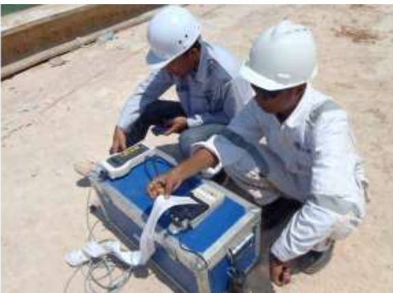
Gambar 2: Proses print data dengan JMC Scotload
