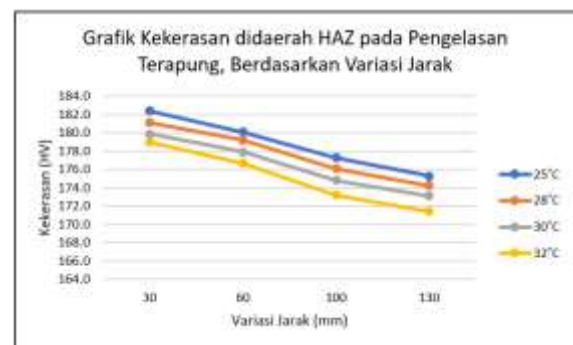
Gambar 11: Grafik Kekerasan Di Daerah HAZ Pada Pengelasan Di Atas Permukaan Air Berdasarkan Variasi Jarak
