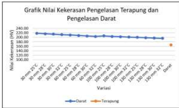
Gambar 17: Grafik Nilai Kekerasan Pengelasan Di Atas Permukaan Air Dan Pengelasan Darat Di Daerah Weld Metal
