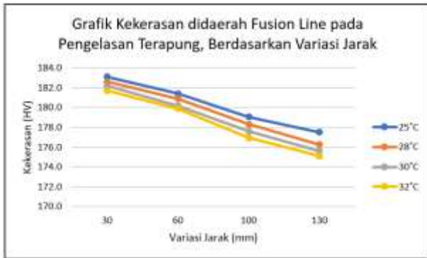
Gambar 13: Grafik Kekerasan Di Daerah Fusion Line Pada Pengelasan Di Atas Permukaan Air Berdasarkan Variasi Jarak
