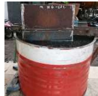
Gambar 2: Setting Pengelasan Dengan Variasi Jarak 60 Mm
