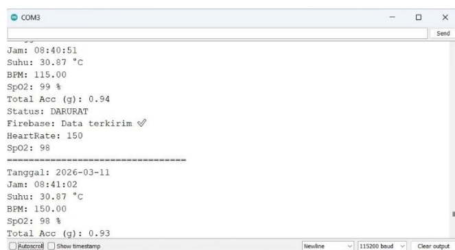
Gambar 9 Serial Monitor Pembacaan Data Sistem
