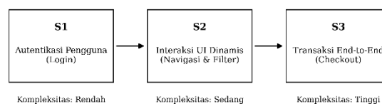
Gambar 2. Alur dan Tingkat Kompleksitas Skenario Pengujian
