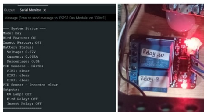
Gambar 9. Serial monitor dan relay mode siang yang tidak mendeteksi gerakan
