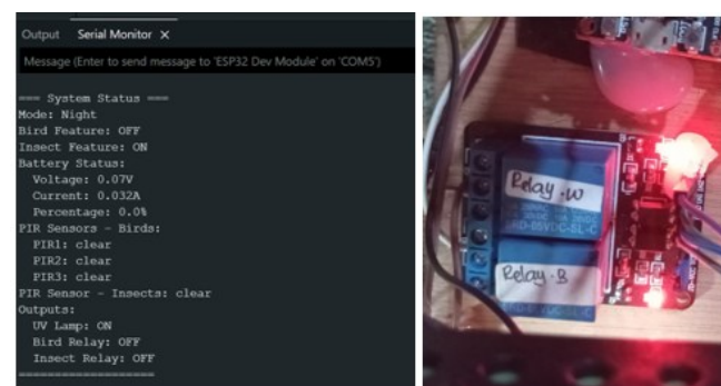
Gambar 11. Serial monitor dan relay mode malam yang tidak mendeteksi gerakan
