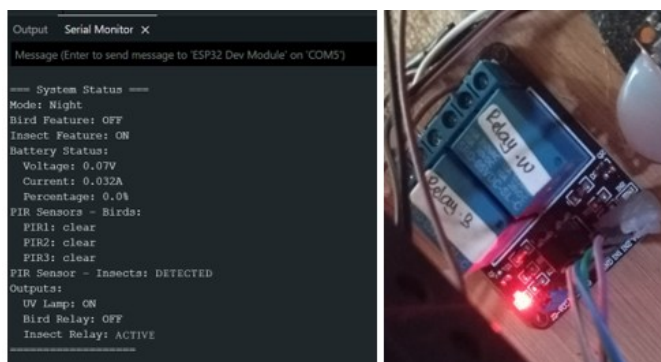
Gambar 12. Serial monitor dan relay mode malam yang mendeteksi gerakan
