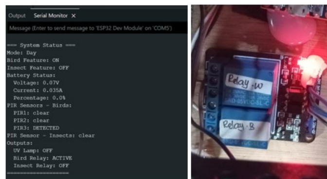
Gambar 10. Serial monitor dan relay mode siang yang mendeteksi gerakan
