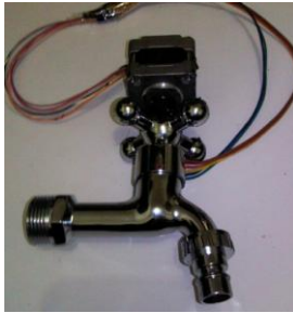
Gambar 15. Motor stepper pada kran air
