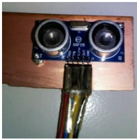
Gambar 14. Rancangan sensor ultrasonik SRF04
