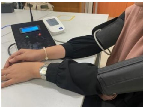
Gambar. 6. Pengujian perbandingan sensor MPX5700DP dengan tensimeter digital
