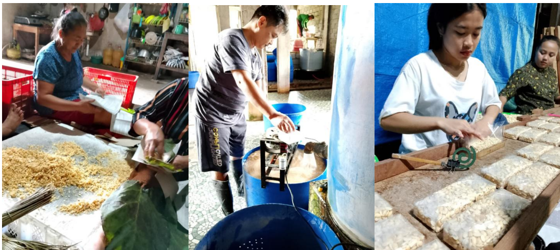
a) Pembungkusan tempe dengan daun pisang b) Alat penggilingan c) Pembungkusan tempe dengan plastic
