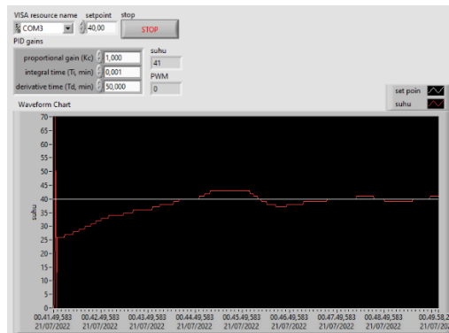
Gambar 7. Hasil Percobaan Sistem PID Tunggal
